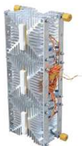
UTS300-1250A三相全控桥 长X宽X高: 495X175X220
